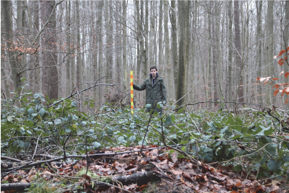
Figuur 6: Opname van zichtbaarheid aan de hand van opmeten van aantal zichtbare banden van meetbaken (Stanislas Sibille, Hogeschool Condorcet)
